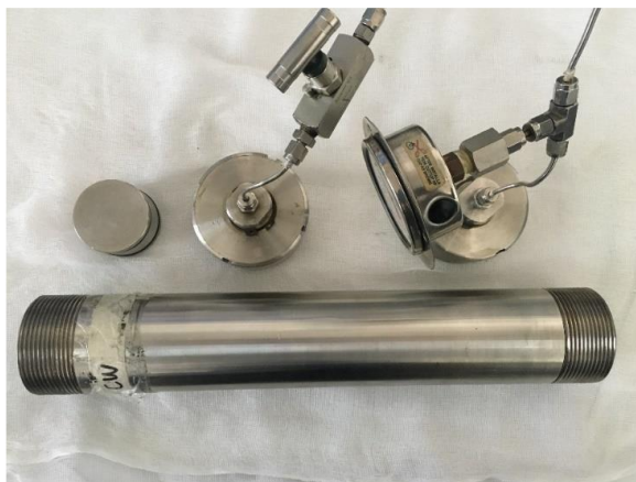
شکل ۴: نمای کلی انباشتگر سیال
